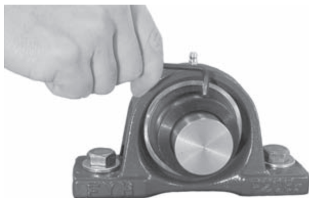
图 14.10 偏心固定圈的安装
