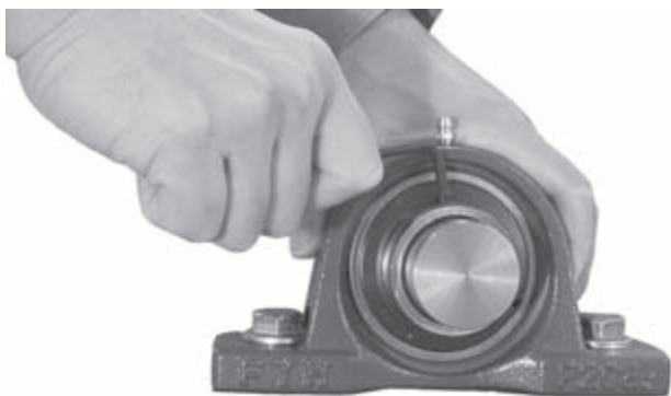
图 14.5 止动螺钉的安装
