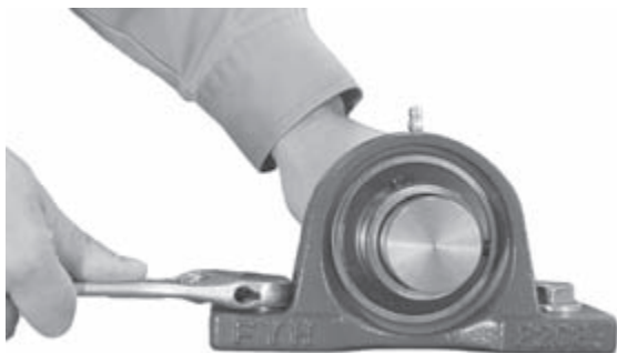
图 14.4 将轴承组件固定在底座上
